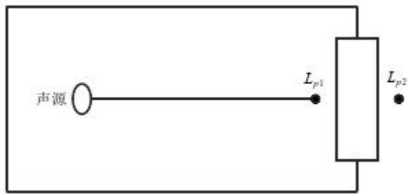
图6. 室内声源等效为室外声源图例
